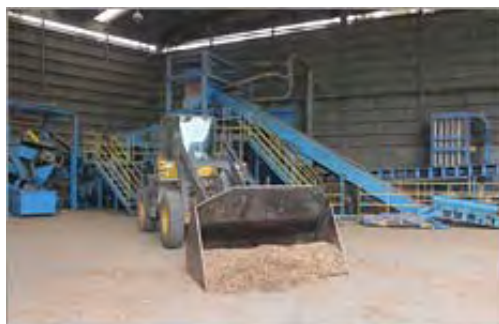
解体系木くずライン。木くずは約5cm四方に細かく碎いて木質チップにします。
