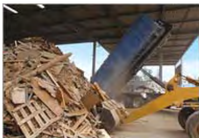
木くずの破碎施設。運ばれた木くずをここで選別します。
