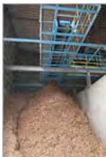
解体系木くずライン。木くずは約5cm四方に細かく碎いて木質チップにします。
